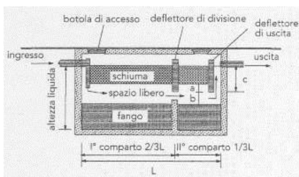
Figura 3.2 – Schema di fossa settica a due camere.
