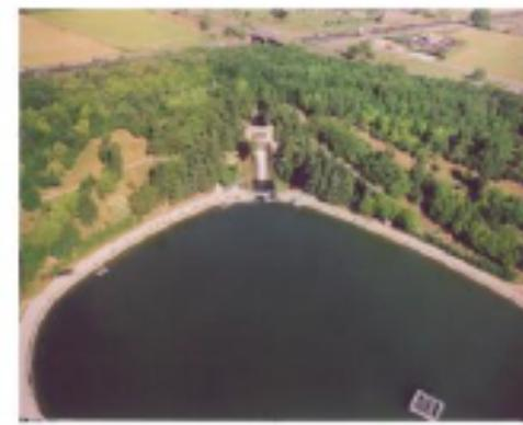
**1985** Veduta aerea per la realizzazione del lago. In basso sono visibili i lavori per la costruzione della diga, nella parte alta il manufatto della cascata non che la modellazione delle scarpate.
